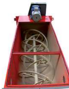
◀ Mélangeuse horizontale avec vue des spires
